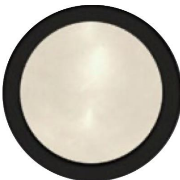
図10 漂白された蛍光膜：蛍光発光しなくなり、白色になっています。
