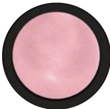
図9 新品の蛍光膜：室内光で蛍光膜を透過した時、ピンク色をしています。
