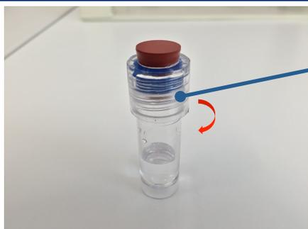
電極締め付けリングを時計方向に回し、保管ケースから外れないようにします。
