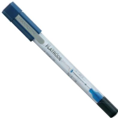
接触と感度を確実にするため接触面は水平に磨かれ、測定ガラス面積を最大になるように設計、また液絡部は測定ガラス面と同一面上に組み込むことで測定対象表面より 1mm の挿入で感度が取れるようにしています。
