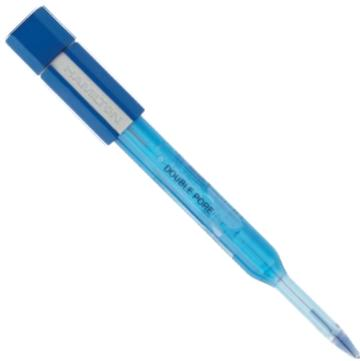
接触と感度を確実にするため接触面は槍型になっており、液絡部は槍形状の根元の部分に二箇所目詰まりを起こさないポア（細孔）を設けています。
