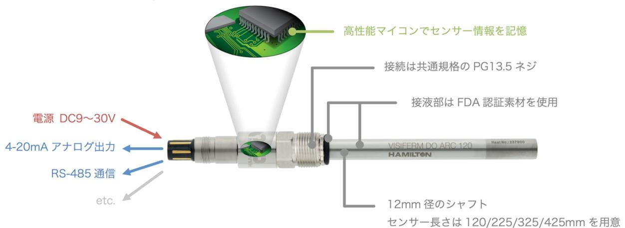
アークセンサーシリーズはセンサーの中にマイクロコンピュータを内蔵し、従来の計測器の機能を小さな12mmの円筒の中に収めました。
