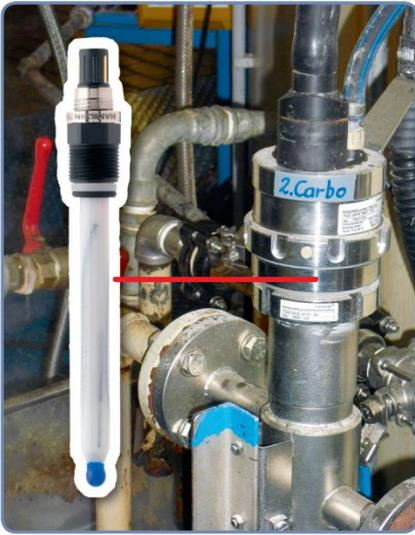
図 2：炭酸化工程に設置された pH 電極
